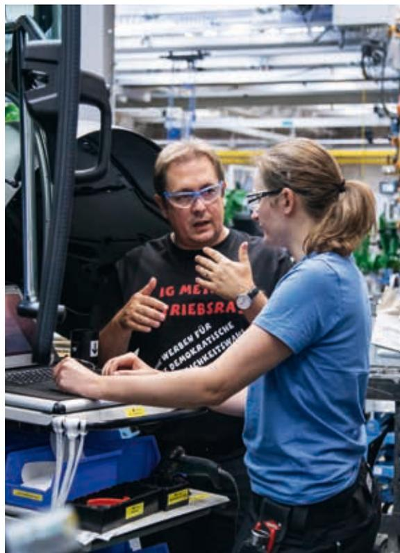
Lucas Schmitt steht am Produktionsband für den Antriebsstrang. Er prüft während der Montage seine Arbeit mit einem Tablet. Die Tablets sind vernetzt, Sender und Empfänger gleichzeitig. So erhalten sowohl Lucas als auch sämtliche Verantwortlichen über den sogenannten Informationshub alle notwendigen Informationen über einen möglicherweise entstandenen
